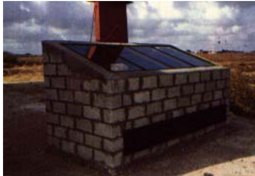
FIGURA 16: Secador solar fijo, de construcción sólida, en hormigón, metal y vidrio.
