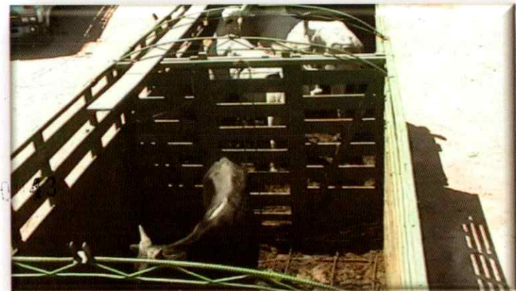
Subdivisiones y piso con rejas
