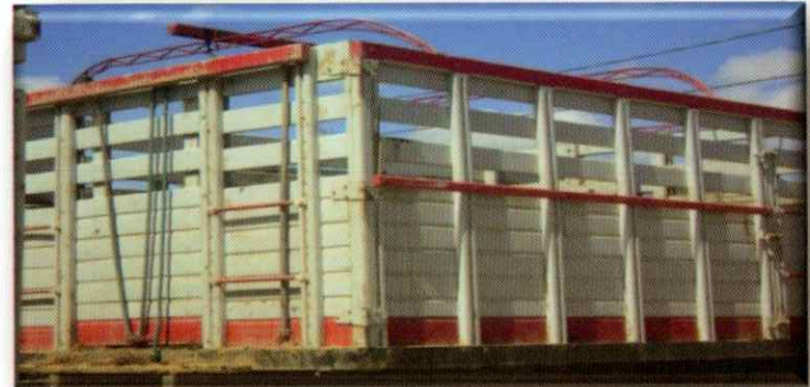
Camión con buena ventilación
