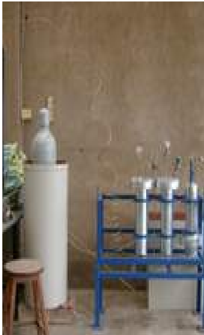
Ilustración ET11: Equipo para procesar insecticida natural de piretro
