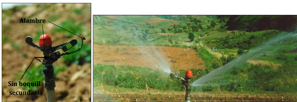
FIGURA 2. LA INFLUENCIA DEL ALAMBRE SOBRE EL CHORRO DE AGUA SALIENTE DEL ASPERSOR
