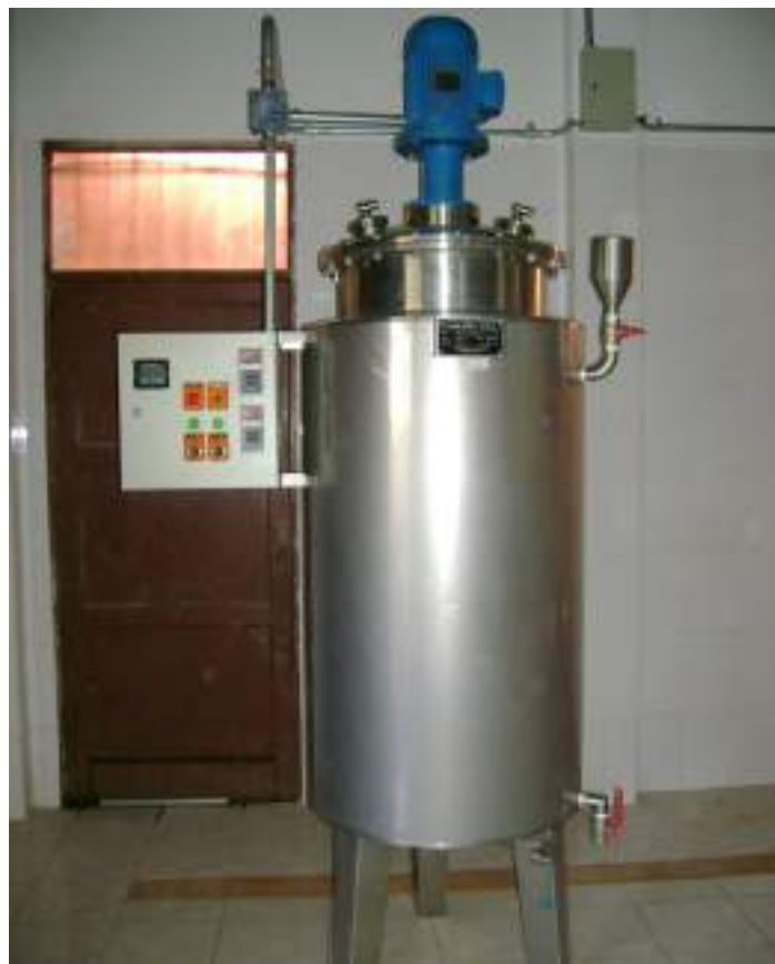
Ilustración ET12: Equipo de sulfonación a escala de planta piloto
