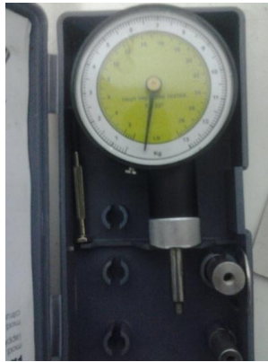
Figura 8. Penetrómetro utilizado para medir la presión necesaria a la ruptura de la epidermis.
