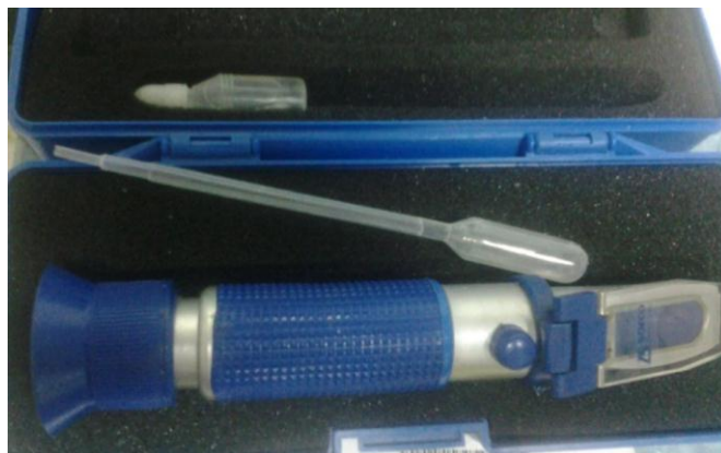
Figura 9. Refractómetro utilizado para medir los grados Brix del jugo de tomate nativo.
