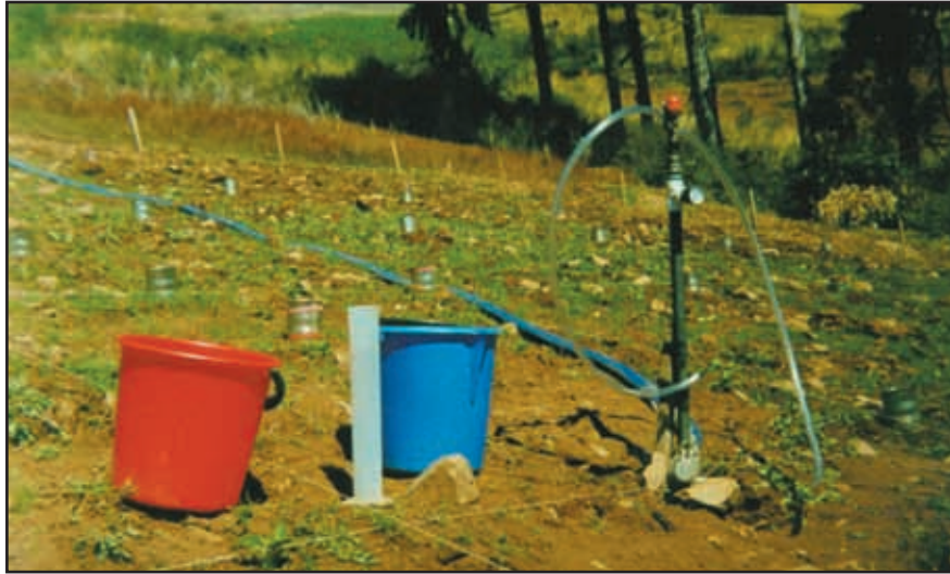
FOTO 9. MATERIALES UTILIZADOS EN EL AFORO DEL ASPERSOR.
