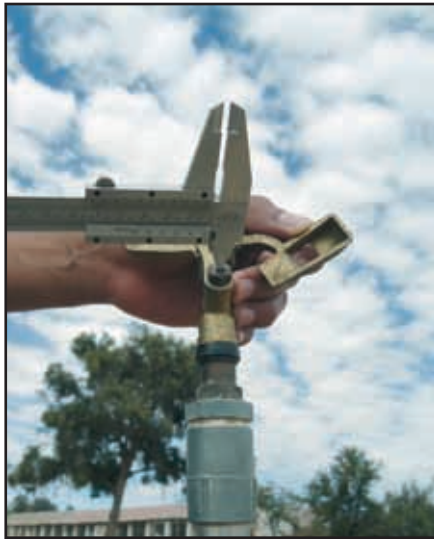
FOTO 1. MEDICIÓN DEL DIÁMETRO DE LA BOQUILLA DEL ASPERSOR
