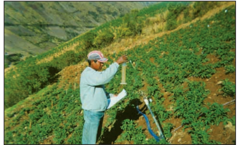
FOTO 8. MEDICIÓN DEL AGUA RECOGIDA EN LOS PLUVIÓMETROS CON UNA PROBETA.
