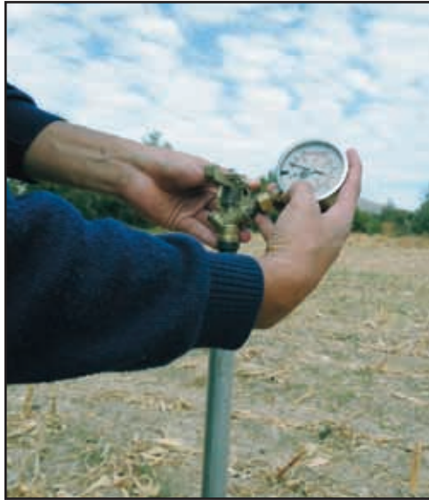
FOTO 3. MEDICIÓN DE LA PRESIÓN DE FUNCIONAMIENTO DEL ASPERSOR.
