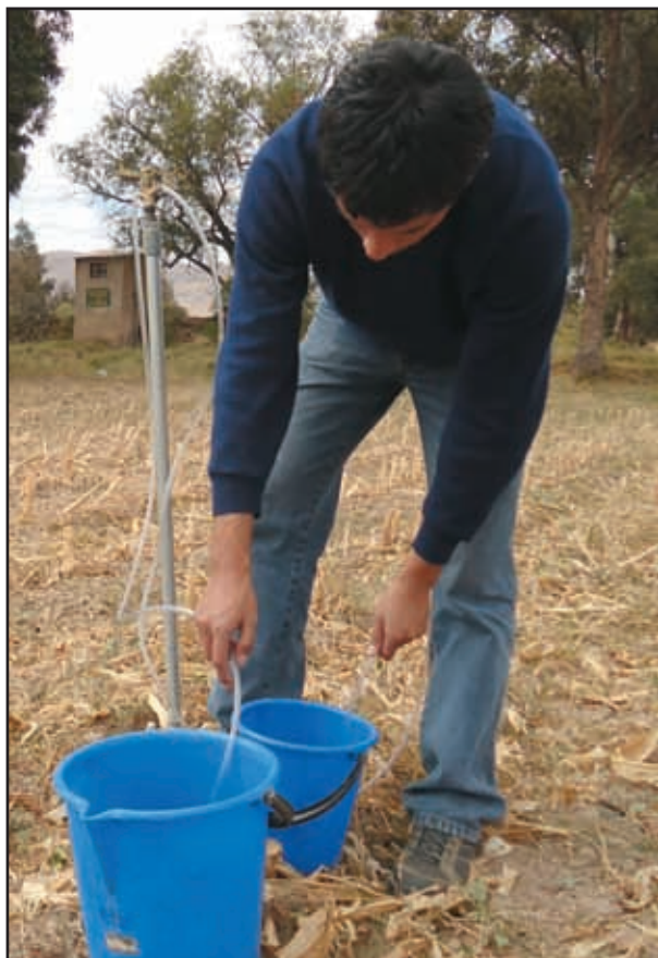
FOTO 5. AFORO DEL CAUDAL DE SALIDA DEL ASPERSOR
