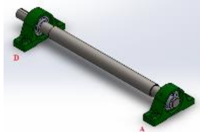
Figura 3.18: Rodamiento del sistema de rallado
