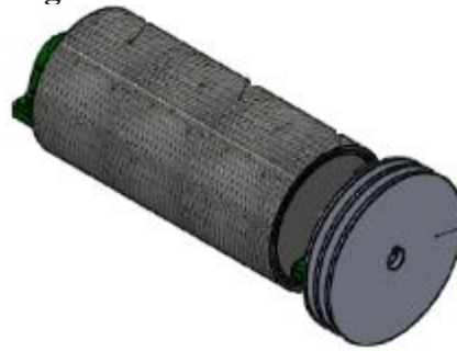
Figura 3.3: Sistema de rallado
