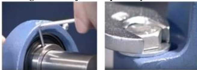
Figura 6.2: Ajuste de pernos y tornillos
