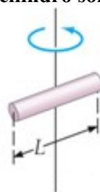
Figura 2.10: Inercia de un cilindro sólido respecto a su eje vertical.
