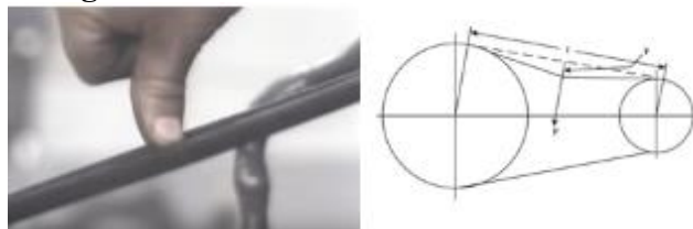
Figura 6.3: Control de tensión de correas
