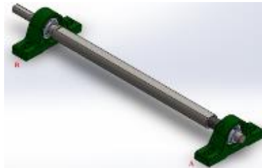
Figura 3.25: Rodamiento del sistema de picado
