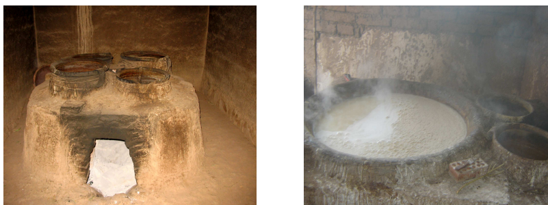
Figura 35. Infraestructura de las Manka Akhas (elaboración de chicha en ellos de barro) Izquierdo. Cuatro ollas de barro empotrados en un fogón. Derecho. Perol de cobre combinado con dos ollas de barro en la parte posterior.
