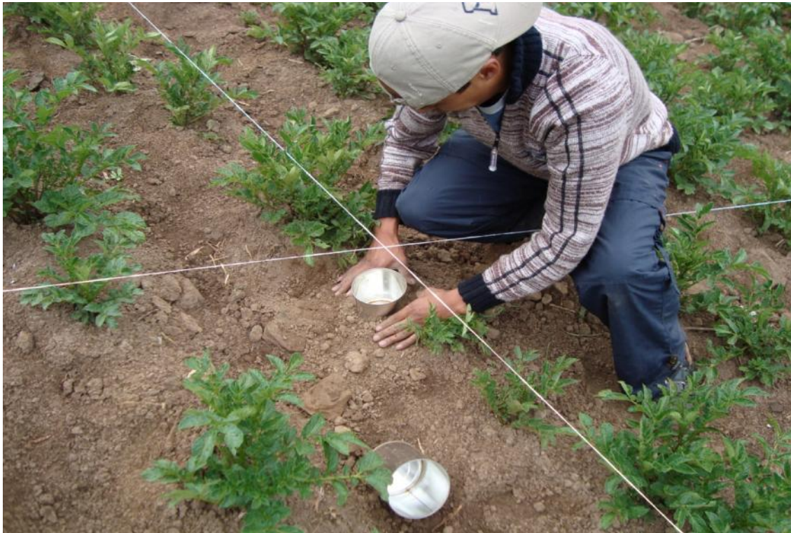
Fig. 9 Instalación de la red de pluviómetros en la parcela con espaciamiento de 3X3m.
