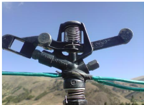
Fig. 29 Aspersor Rain Bird con alambre.
