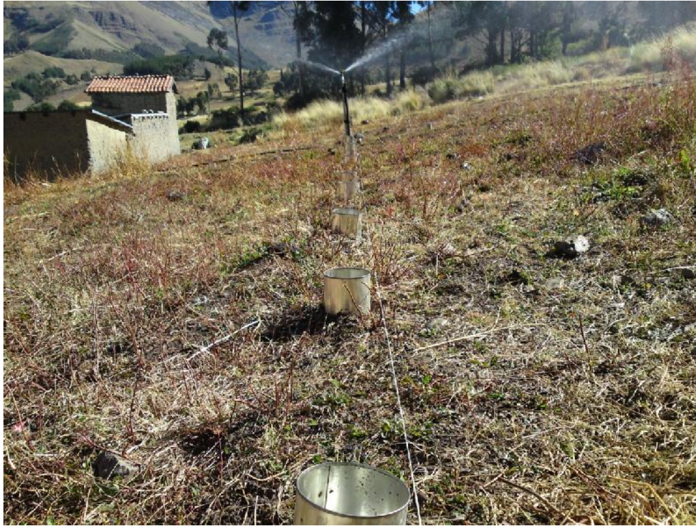
Fig. 10 Red de pluviómetros armado para la evaluación de curvas de humedecimiento con un espaciamiento de 1x1m en forma de cruz.
